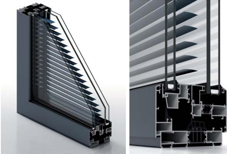
Sistema de doble ventana abisagrada con Rotura de Puente Térmico diseñada para garantizar una total protección contra la contaminación acústica exterior y proporcionar el máximo aislamiento térmico. Presenta la posibilidad de incorporar un sistema de protección solar: estore o veneciana en la cámara interior entre hojas. Accesibilidad a esta cámara para limpieza y mantenimiento.
